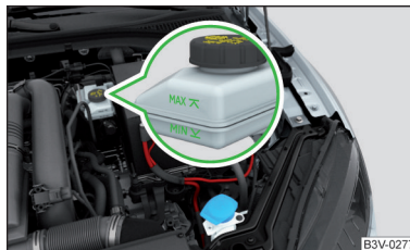
Rys. 221 Zbiornik płynu hamulcowego
